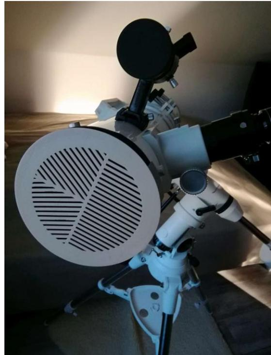
Diese Maske wird benutzt, um das Bild im Okular scharf zu stellen. Man setzt die Maske vorne auf das Teleskop und richtet es dann auf einen hellen Stern oder Planeten.
